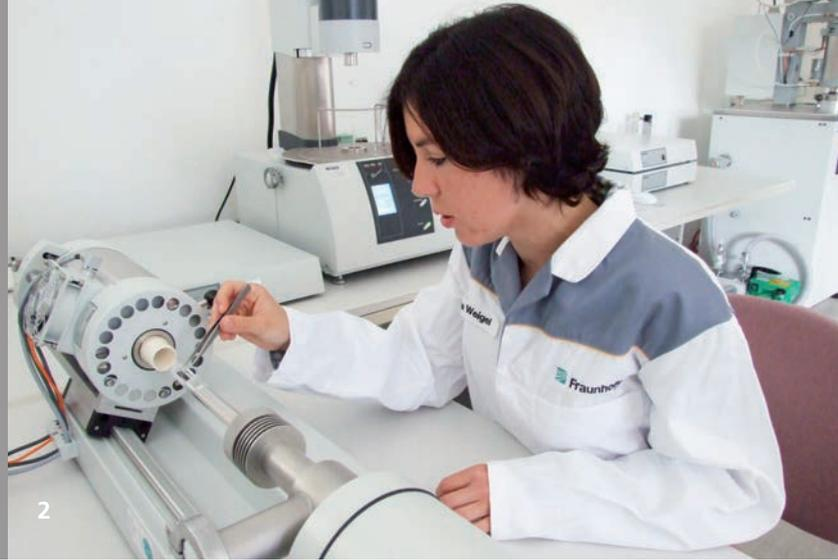
Zur Ermittlung von thermisch-physikalischen Werkstoffkennwerten steht am Fraunhofer IWU eine Vielzahl von Prüfeinrichtungen zur Verfügung, die letztendlich der Berechnung der Wärmeleitfähigkeit nach  $\lambda(T) = a(T) \cdot c_p(T) \cdot \rho(T)$  dienen. Mit den nachfolgend aufgeführten Prüfeinrichtungen können diese prozessunabhängig für eine thermomechanisch gekoppelte Simulation gewonnen werden.
